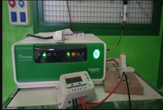
INVERTER ( PENGUBAH ARUS DC KE AC 220 VOLT UNTUK INSTALASI LISTRIK )
